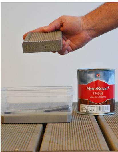
Schnittkanten müssen zwingend mit „MøreRoyal®-Holzöl“ behandelt werden. Hier sollte darauf geachtet werden, dass ausreichend Öl aufgetragen wird, damit ein Schutz gegen eindringende Feuchtigkeit und daraus resultierende Fäulnis erstellt wird.
